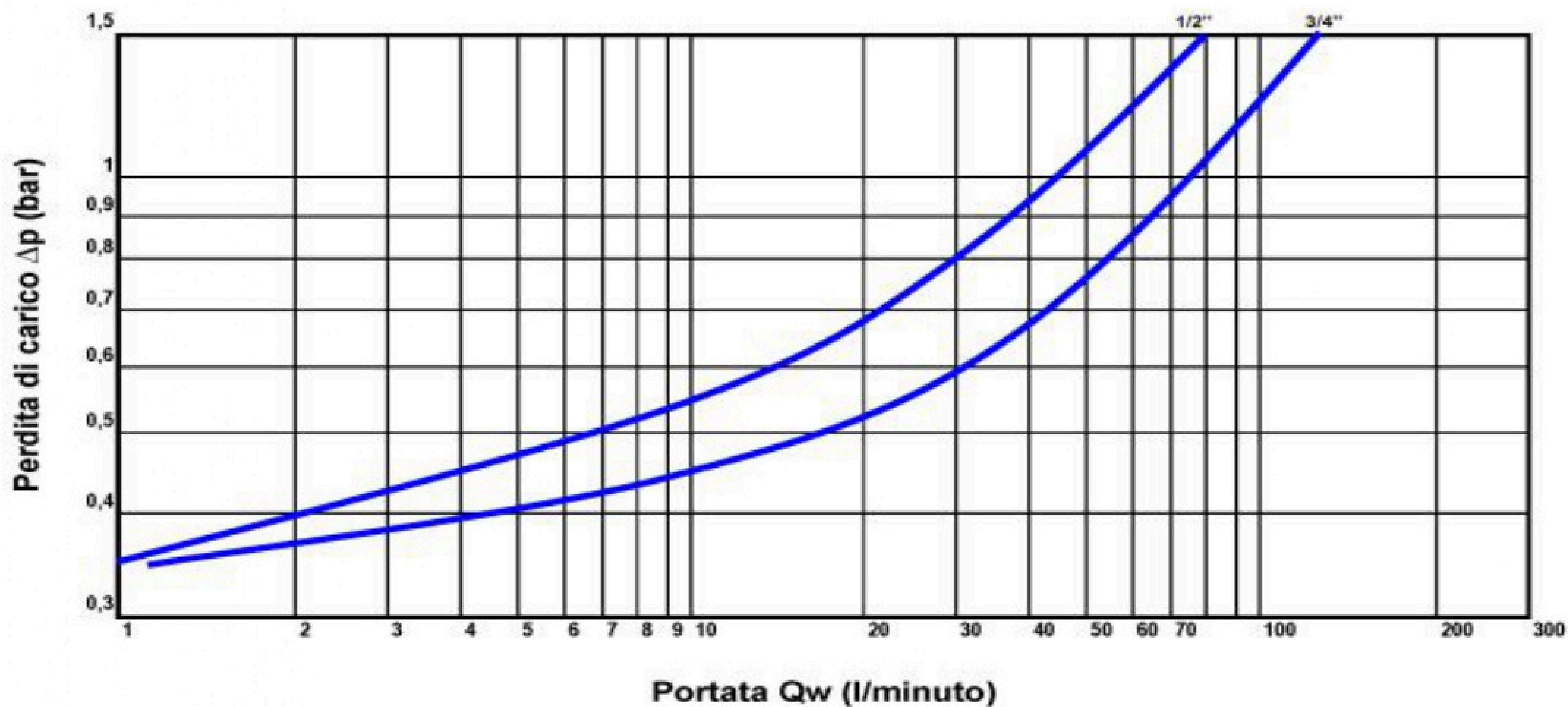
DIAGRAMMA DI PORTATA E PERDITA DI CARICO - DISCHARGE AND HEADLOSS DIAGRAM
